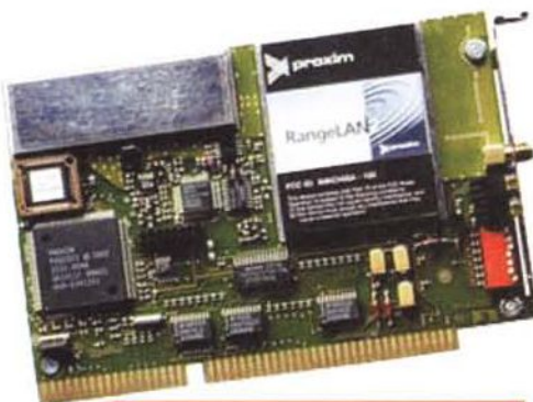
Una tipica scheda wireless radio-LAN in tecnologia Spread Spectrum.
